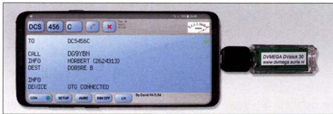
Bild 1: DVstick 30 an einem Smartphone Samsung S9+, angeschlossen und mit Strom versorgt über einen OTG-Adapter
