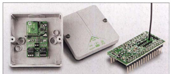
Bild 18: Neben zahlreichen Selbstbausätzen für die „normalen“ Komponenten verfügt das System HmIP über kleine Platinenbausätze, die sich einfach in eigene Applikationen einbauen lassen.
