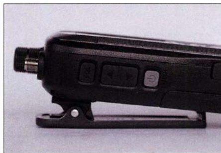
Bild 5: Der rückseitig ansteckbare Gürtelclip dient dem Empfänger auch als Stütze. Auf der linken Gehäusesseite ergänzen vier Tasten das frontseitige Bedienfeld.
