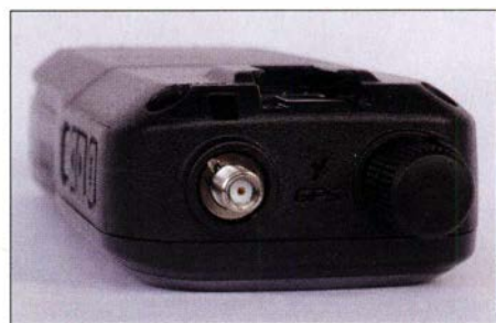
Bild 2: Der integrierte GPS-Empfänger samt Antenne liegt im oberen Bereich des IC-R30.
