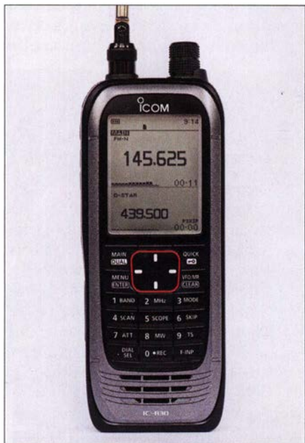
Bild 1: Icoms neuer Breitbandempfänger IC-R30 erfasst Signale bis in den GHz-Bereich. Fotos und Screenshots: DL1ABJ
