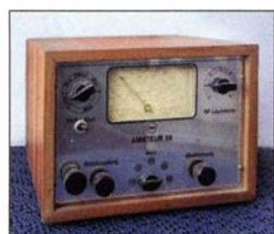
Liebevoll aufgebauter Audionempfänger 0-V-2 für die fünf klassischen Amateurbänder auf Basis eines Bausatzes von RIM, 1958
