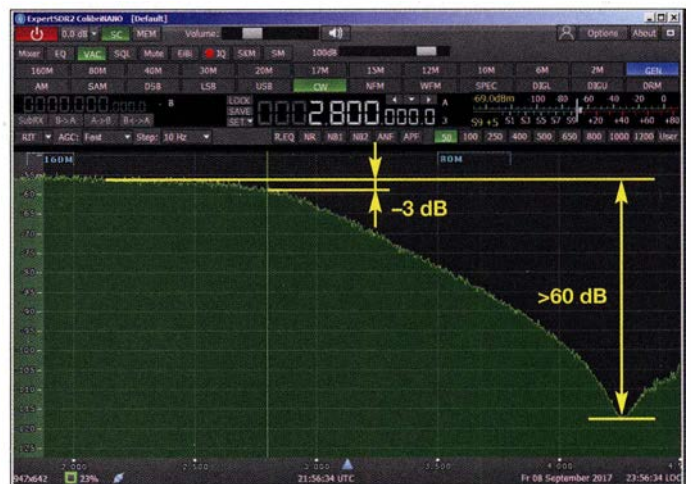
Bild 3: Mit dem Colibri-Nano gemessene Übertragungskurve eines 2,8-MHz-Tiefpassfilters Screenshots: DC4KU
