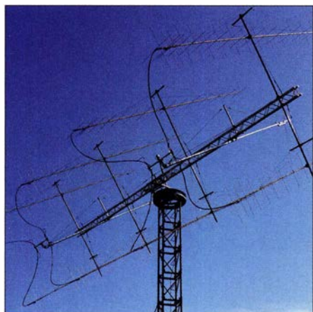
Die acht Yagi-Antennen von DK5LA erreichen einen Gewinn von etwa 23,5 dB in jeder Ebene. Der Drehkranz der Konstruktion stammt aus einem Panzer des Typs Marder. Foto: DF2ZC
