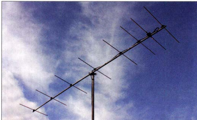
Bild 1: Fertig montierte, von DK7ZB neu entwickelte Antenne mit nur acht Elementen Fotos: DK7ZB
