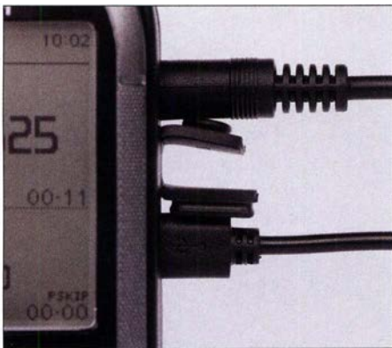
Bild 4: Auf der rechten Gehäusesseite schützen Gummibedeckungen die Buchsen für NF-Ausgang und USB-Schnittstelle.
