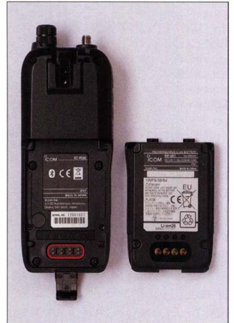
Bild 6: Der mitgelieferte Akkumulator wird hinten aufs Gerät gesteckt und verriegelt.
