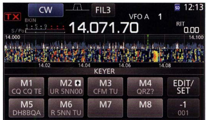
Bild 1: So präsentiert sich das Bandscope des IC-7300 in voller Pracht und maximaler Größe bei hoher Signaldichte auf dem Band.
