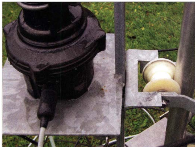
Bild 14: Rotorplattform und eine Rolle des Schlittens mit ihrer flachen breiten Nut im Mittelteil. Diese ist erforderlich, um über die Stifte zu kommen, welche die Verbindungskonusse sichern. Die Stifte sind gekürzt, müssen aber geringfügig heraus schauen. Scheiben halten die Rolle mittig und ein Langloch erlaubt das Einstellen der Rollen für einen Lauf mit wenig Spiel.
