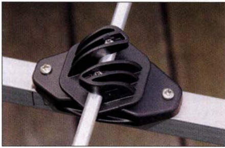
Bild 8: Weidezaunisolatoren wie dieser eignen sich gut als Elementhalter.
