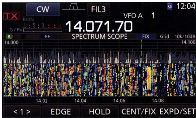
Bild 2: Die Tasten der Speichersteuerung nehmen einen Großteil des Displays ein, fürs Bandscope bleibt dann kaum noch Platz.
