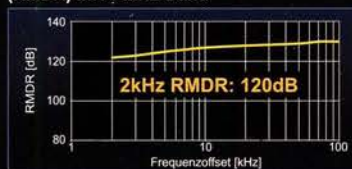
Dynamikbereich für reziprokes Mischen (RMDR) im 14-MHz-Band
